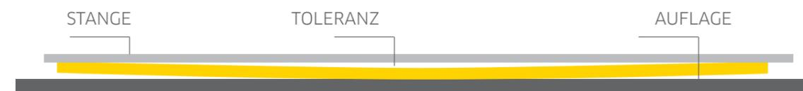
Anordnung für korrekte Messung des Verzugs.
